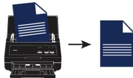
Для обеспечения правильности сканирования документов сканер ADS-2100 автоматически исправляет перекося документов, подаваемых в устройство.
