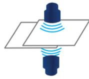
Для предотвращения одновременного сканирования нескольких документов в сканере ADS-2100 используется технология ультразвукового обнаружения мультимодачи, которая исключает пропуск документов при сканировании.
