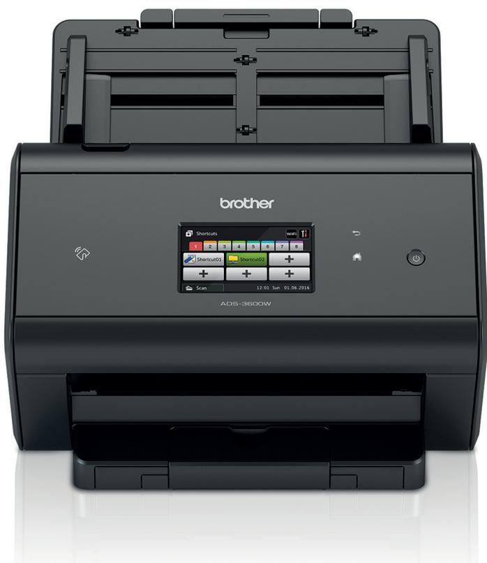
Система обнаружения мультиподачи работает на основе ультразвукового датчика. В случае обнаружения необычного сигнала тракт подачи бумаги блокируется, а пользователю отправляется соответствующее уведомление. Это исключает риск повреждения документов и потери данных.
